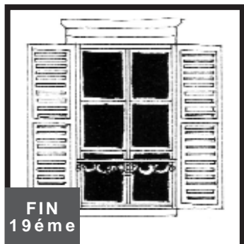
Proportion : 1/1,5 Volets bois Garde-corps en tableau
